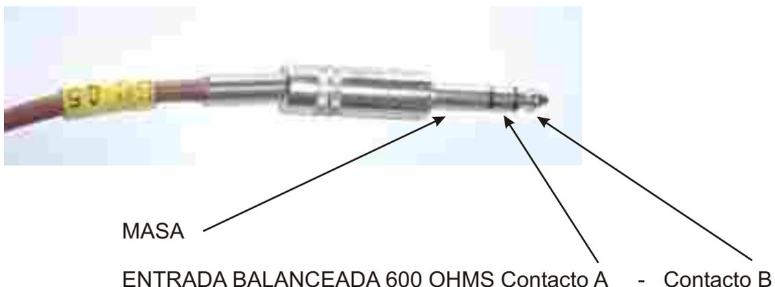
Para entrar en modo Desbalanceado Utilizar Plug Mono de forma tal de que el contacto A quede conectado a masa y la entrada de audio sera entre masa y contacto B.
